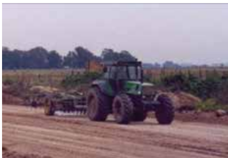
Imagen N° 29 – Arado de discos arrastrado por tractor
