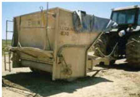
Imagen N° 26 – Distribuidor de cemento tirado con tractor
