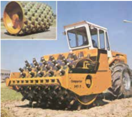
Imagen N° 11 - Pata de cabra autopropulsado
