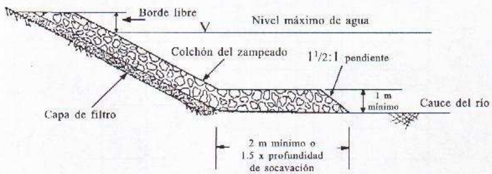
Gráfica B - Detalle del colchón del zampeado hasta el fondo del cauce.
