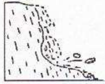
Caída de roca
