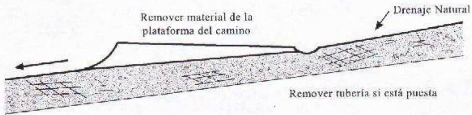
Gráfica A - Camino con peralte hacia afuera en una sección de corte y relleno.
