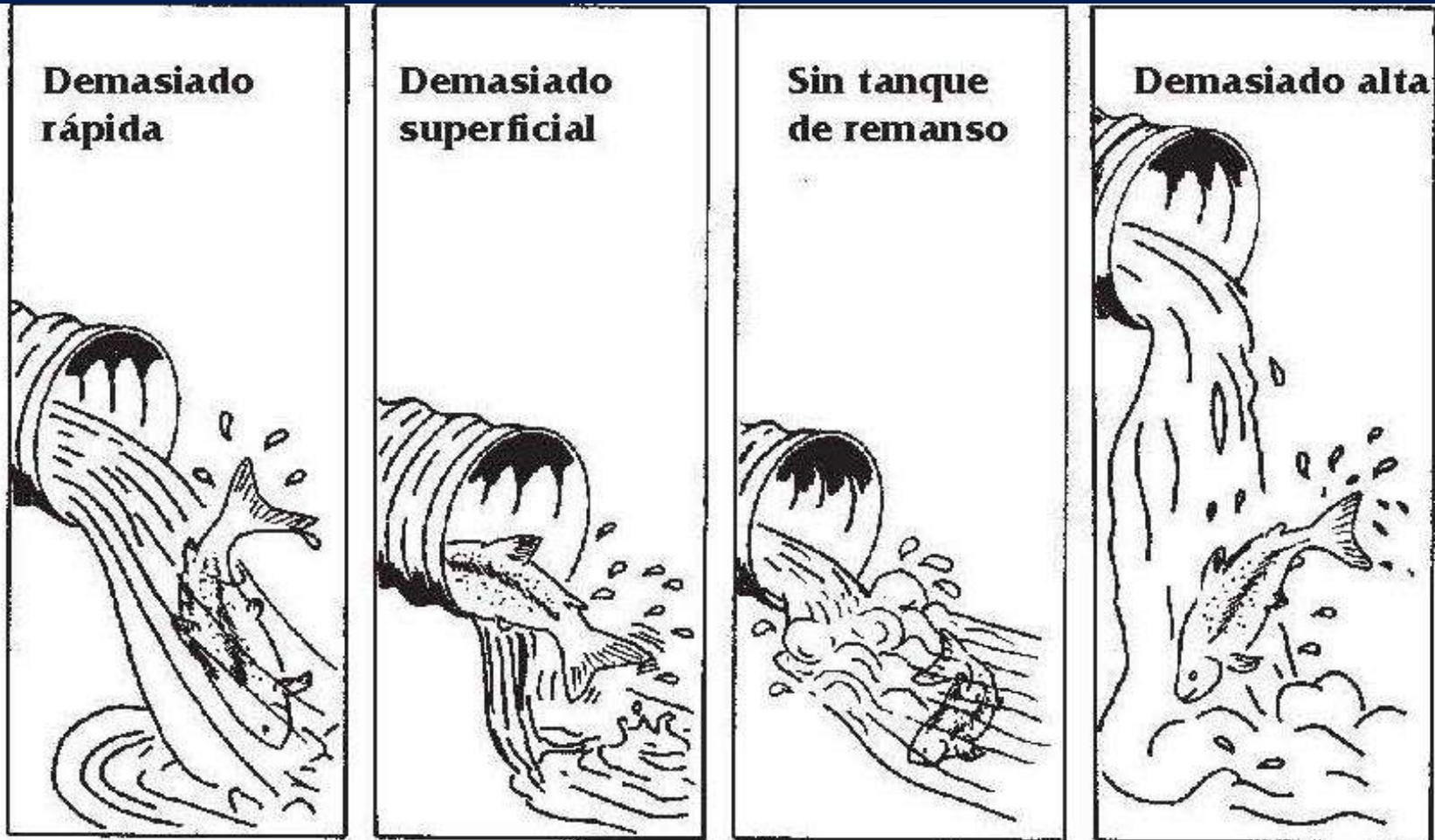
**Figura 2.2b Alcantarillas mal diseñadas o instaladas, con “barreras para peces” que evitan el paso de peces. (Redibujado de Evans and Johnston, 1980.)**
